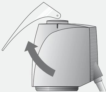
Der TS+ DDC ist durch einfaches Entfernen des Visiers vor Demontage durch Unbefugte gesichert, z.B. am Radiator.
