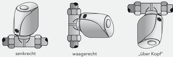
Der Stellantrieb ist bevorzugt in senkrechter und waagerechter Montagelage einzubauen. Bei „Über-Kopf“-Montage können spezielle Umstände (z.B. Schmutzwasser) die Lebensdauer reduzieren.
