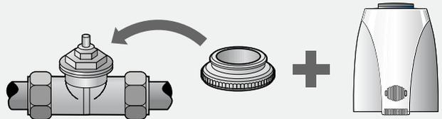
Die Ventilanpassung erfolgt über einen Ventiladapter, der in diversen Ausführungen für die gängigsten Ventilonterteile und Heizkreisverteiler lieferbar ist. (Bitte bei Bestellung berücksichtigen!)
